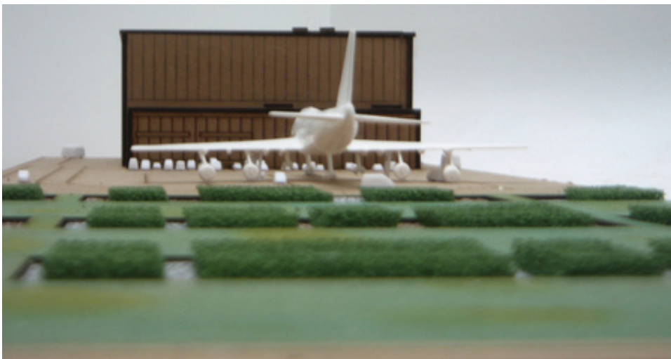
Geluidsreductie door het plaatsen van grindbakken in combinatie met groene geluidschermen bij een testplaats voor vliegtuigmotoren.
